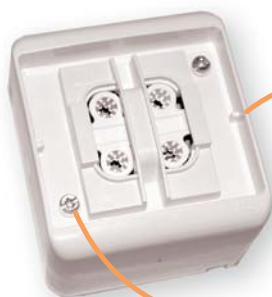
→ Универсальная передняя часть выключателей и розеток позволяет крепить крышку в любом положении, что обеспечивает возможность подвода кабеля как сверху, так и снизу
