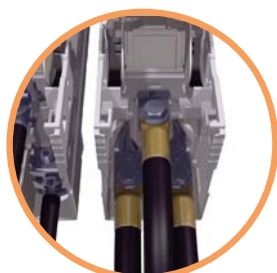
→ Подключение с помощью кабельных наконечников под винт. Также предусмотрена возможность подключения монолитного кабеля сечением до 240 мм 2 и гибких проводников сечением до 300 мм 2
