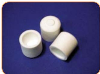
Миниатюрные огнеупорные ёмкости производятся из керамического материала 80% SiO<sub>2</sub>. Изделия используются для точного измерения содержания в веществах углерода и серы.
