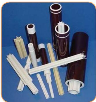
Корпуса высоковольтных предохранителей, производятся из высококачественного фарфорового глинозема С120 с помощью экструзии. Поверхность корпусов покрывается коричневой или белой глазурью (RAL 8011, 8016 или 8017). Отклонение размеров изделий не превышает норм по стандарту DIN 40680.
