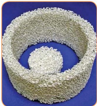
Пористые фильтры производятся на основе SiC. Они используются в промышленности для удаления неметаллических примесей, которые чаще всего становятся причиной поломок при литье. Характерная пористая структура определяет высокую площадь соприкосновения, что обеспечивает высокую степень фильтрации. Расплавленный металл, проходя через фильтр, плотно соприкасается с его пористой поверхностью, оставляя при этом на его стенках даже самые мелкие частицы ненужных примесей.
