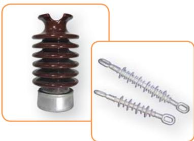
Керамические изоляторы для низкого и среднего напряжения изготавливаются из материала С110 и С120, соответствующего стандарту IEC 672. Они покрываются коричневой или белой глазурью. Коричневая глазурь соответствует RAL 8011, 8016, 8017. Технология производства и параметры изделий соответствуют DIN 40680.
