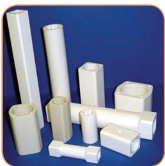
Для изготовления компонентов низковольтных предохранителей используется материал С610 (60 %  $Al_2O_3$ ) и безщелочной стеатит С221. Корпуса для предохранителей серии NH производятся по индивидуальным заказам (размеры, форма, технологические особенности) с помощью экструзии. Поверхность корпуса может быть покрыта специальной глазурью.
